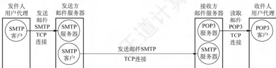
图 6.8 电子邮件系统最主要的组成构件
