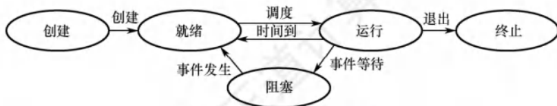
图 2.1 5 种进程状态的转换
